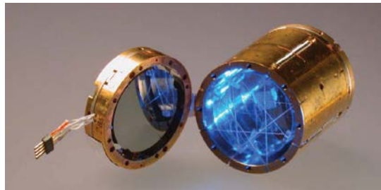
Figura: Imagen de un bolómetro de BGO (derecha) con el disco de Ge utilizado como detector óptico (izquierda).
